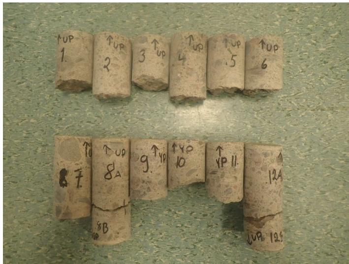
Kuva 24. Otetut näytteet (betoniliერიöt).
